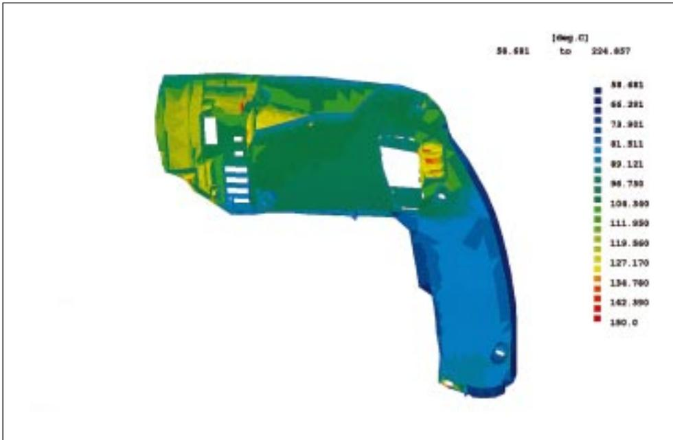
Bild 50: Bohrmaschinegehäuse aus Durethan® BKV 30
