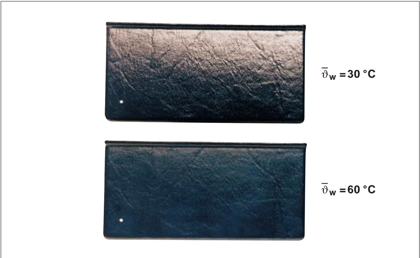
Bild 8: Glanzunterschiede abhängig von der Formnestwandtemperatur – Spiegelgehäuse aus Novodur® (ABS) [5]
